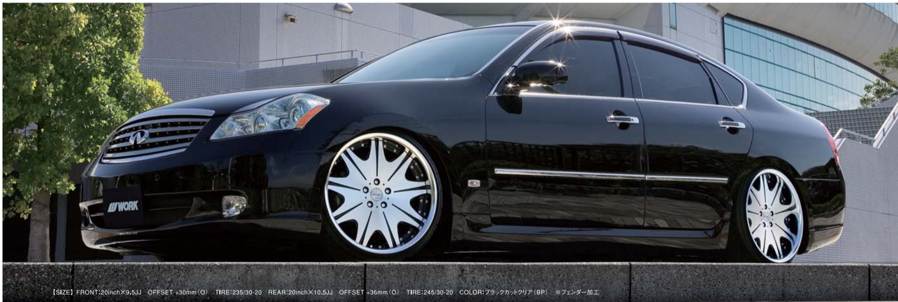
[SIZE] FRONT:20inch×9.5J OFFSET +30mm(O) TIRE:235/30-20 REAR:20inch×10.5J OFFSET +36mm(O) TIRE:245/30-20 COLOR:ブラックカットクリア (BP) ※ファンデーション加工
