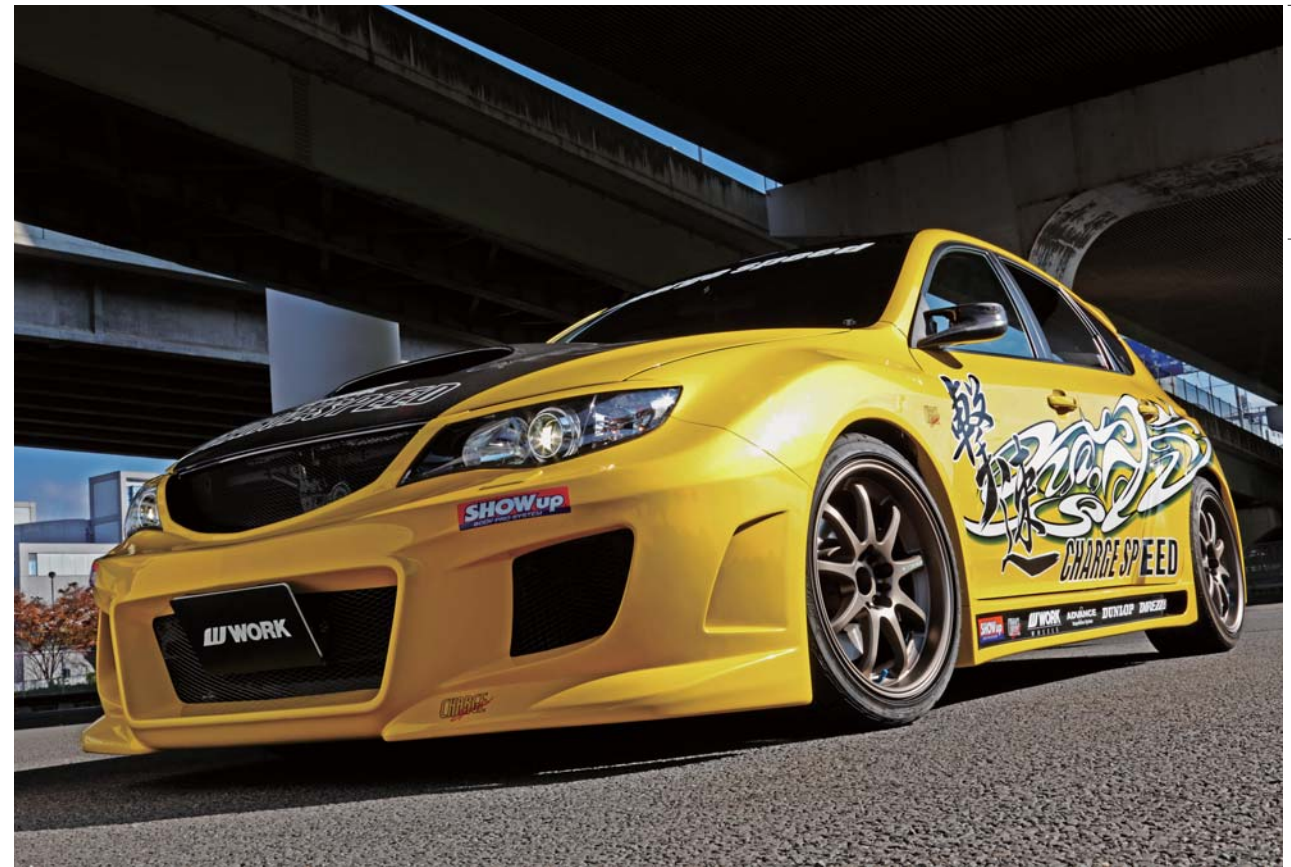
[SIZE] FRONT : 18inch x 9.0J INSET 25mm TIRE : 245/40-18 REAR : 18inch x 9.0J INSET 25mm TIRE : 245/40-18 COLOR : マットチタン (MHG) ※フエンダー加工
