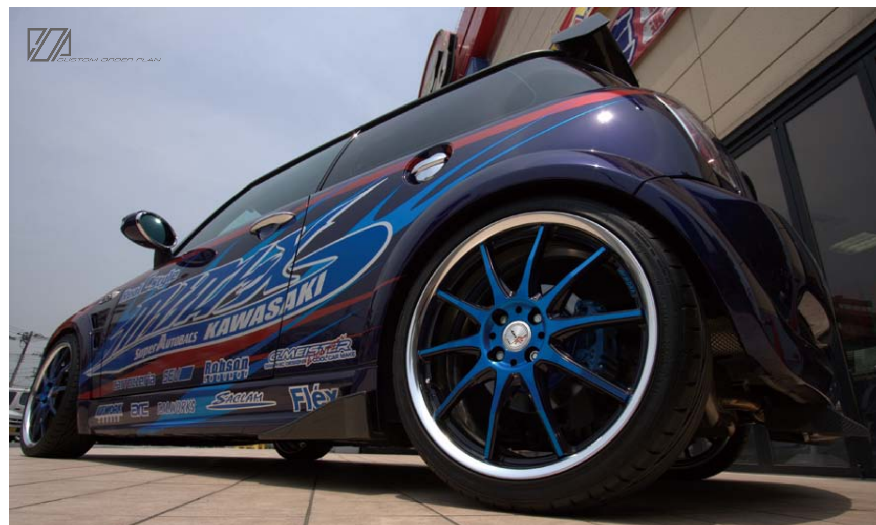
[SIZE] FRONT : 18inch × 7.0J INSET 45mm (O) TIRE : 215/35-18 REAR : 18inch × 7.0J INSET 45mm (O) TIRE : 215/35-18 COLOR : ブラック/クリアブルー (BCB) ※フェンダー加工
