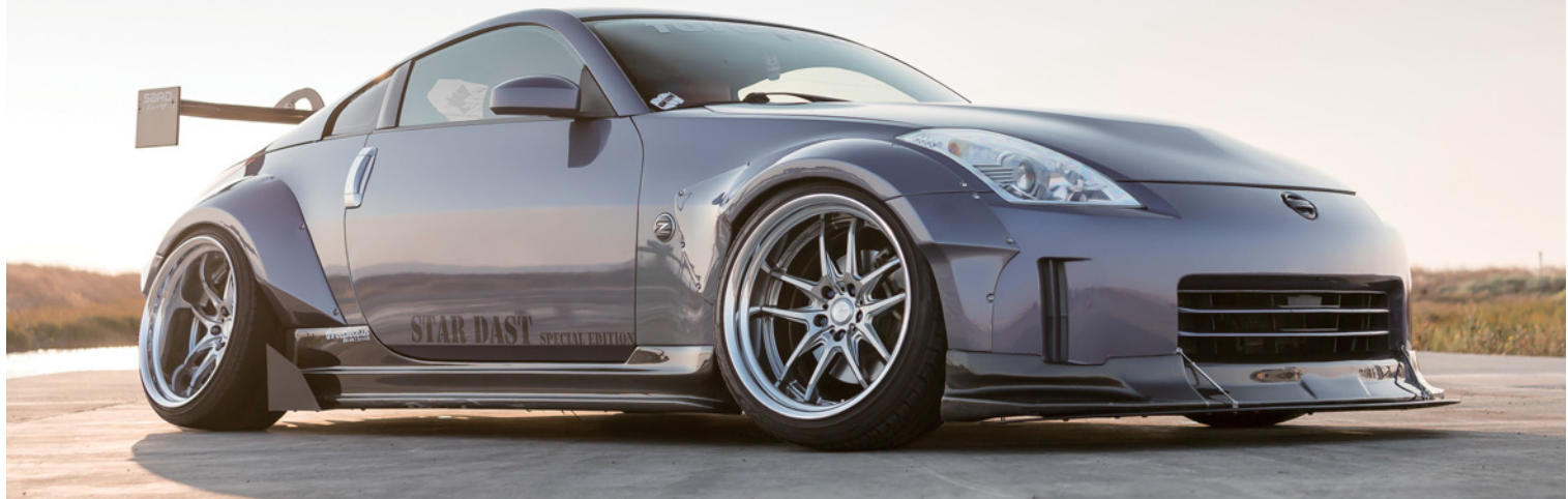
[SIZE] FRONT: 19inch x 11.0J INSET-19mm(R) TIRE: 255/35-19 REAR: 19inch x 11.5J INSET-29mm(O) TIRE: 265/30-19 COLOR: クリスタルシルバー (CS) RIM: STEP RIM
